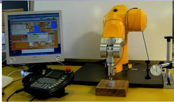
Fig. “Comptage de pièces et test de précision”: Application principalement développée et programmée en Piaget, comprenant le bras de robot industriel visible sur l'image et d'autres ressources: fibre optique, API, camera, table tournante motorisée, servocommande, switch Ethernet, PC and d'autres composants encore.
